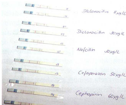
Grenzwertig: Die Rückstands-Höchstmenge von Nafcillin beträgt 30 \mu\text{g/l} . Eigentlich dürfte der mittlere Farbstreifen jetzt gar nicht erscheinen. Doch ist er blasser als der Kontrollstreifen – die Milch ist damit zu verwerfen.
