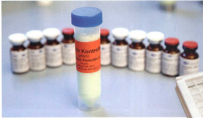
Ab welcher Antibiotika-Konzentration reagiert der Test, bleibt er unter den gesetzlichen Höchstmengen (MRL)? – Mit zwölf so genannten Antibiotika-Standards überprüfte das Labor den Nachweisbereich des Schnelltests Milkguard Combo.
