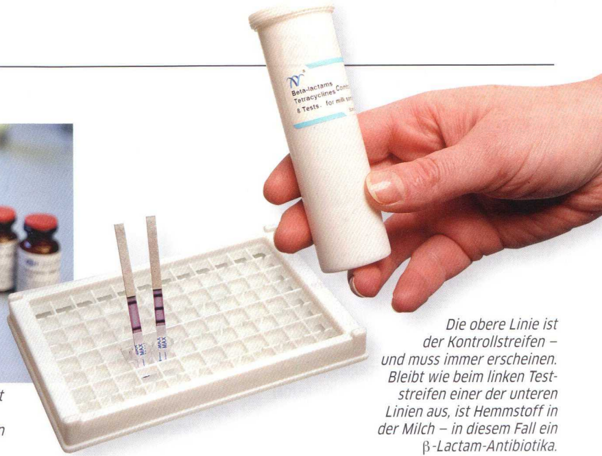
Ab welcher Antibiotika-Konzentration reagiert der Test, bleibt er unter den gesetzlichen Höchstmengen (MRL)? – Mit zwölf so genannten Antibiotika-Standards überprüfte das Labor den Nachweisbereich des Schnelltests Milkguard Combo.
